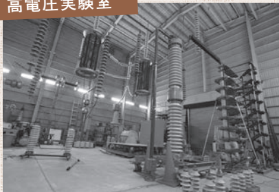
高電圧実験室では、雷を再現した大規模な実験を実施。
